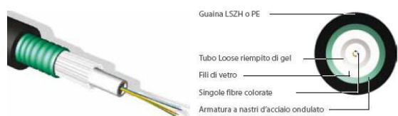
Cavo in fibra ottica armato da esterno
