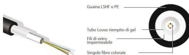
Cavo in fibra ottica di tipo loose
